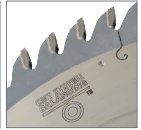
Fig. 2 Eksempel på klinge i perfekt balance.
