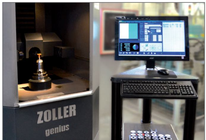
CMT's fuldautomatiske måleapparat.
